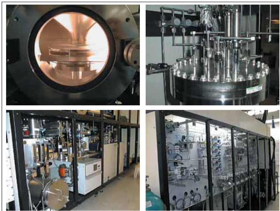
Рис. 5. Общий вид установки газозофазной эпитаксии в IRnova
