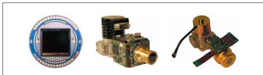
Рис. 8. QWIP-датчик и готовые модули на его основе
